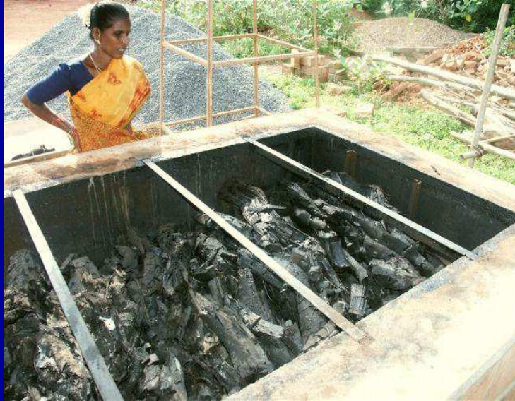
Sistema avanzado para la producción de carbón vegetal tipo "retort" en India
